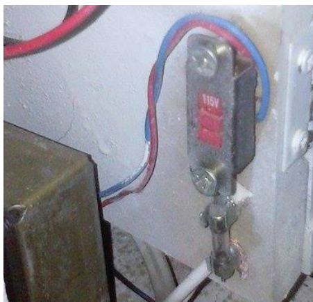
Figura 12. Chave seletora de voltagem
