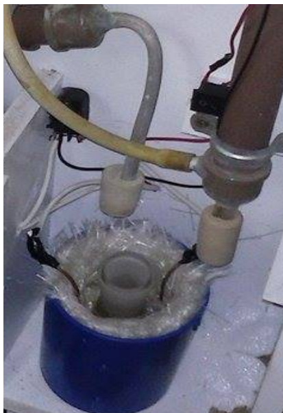
Figura 14. Imagem da manta de aquecimento com o balão de 50ml pronto para ser encaixado.
