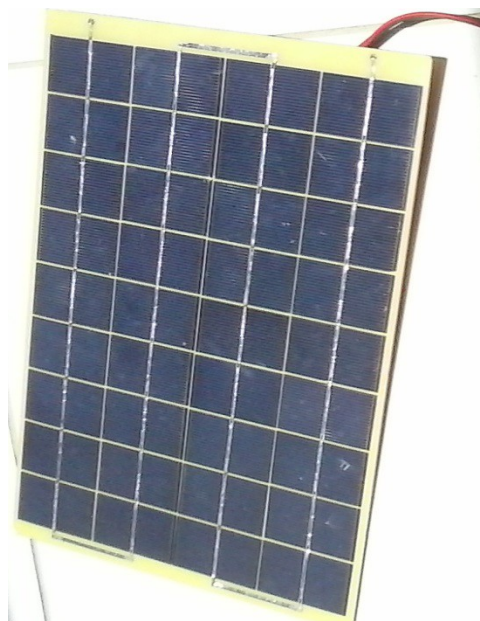
Figura 4. Placa solar de dimensões 41x21x0,3cm, vista frontal.
