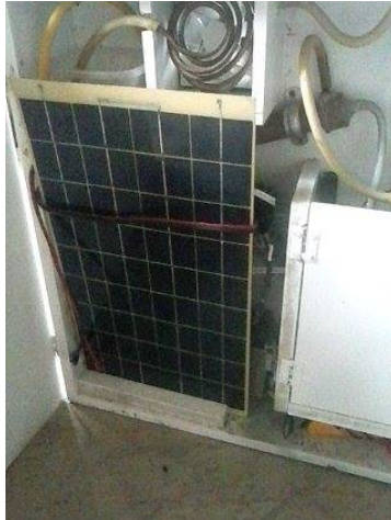
Figura 10. Posição da placa solar dentro do aparelho.
