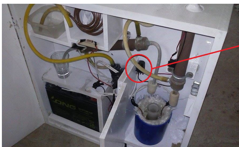
Figura 15. Aparelho com indicação da posição da chave interruptora para acionamento da manta.
