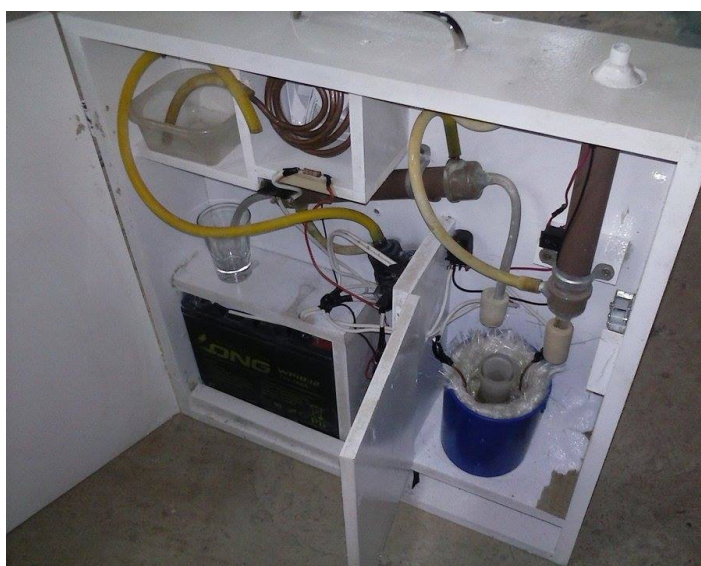
Figura 5. Vista frontal da caixa do sistema de refluxo e destilador.
