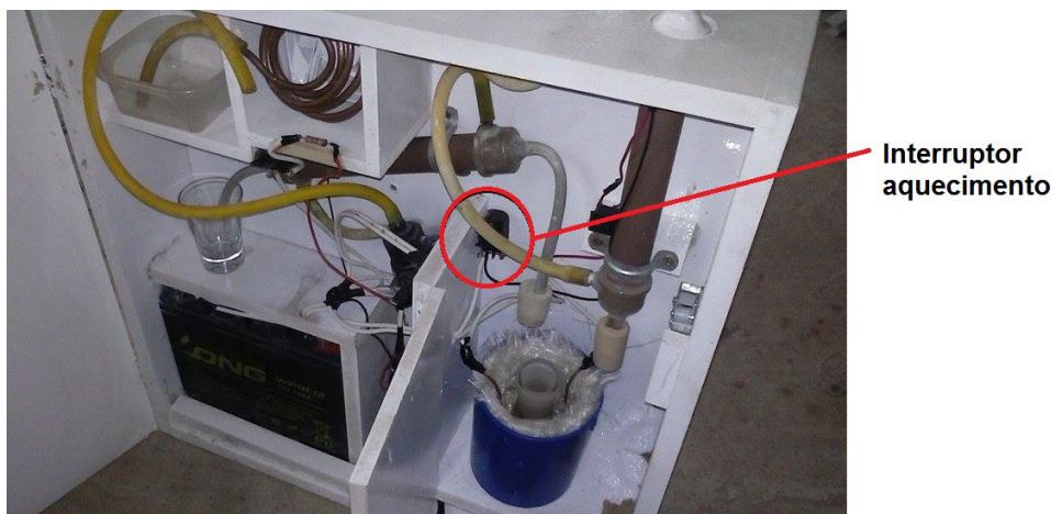
Figura 17. Aparelho com indicação da posição da chave interruptora para acionamento da manta.
