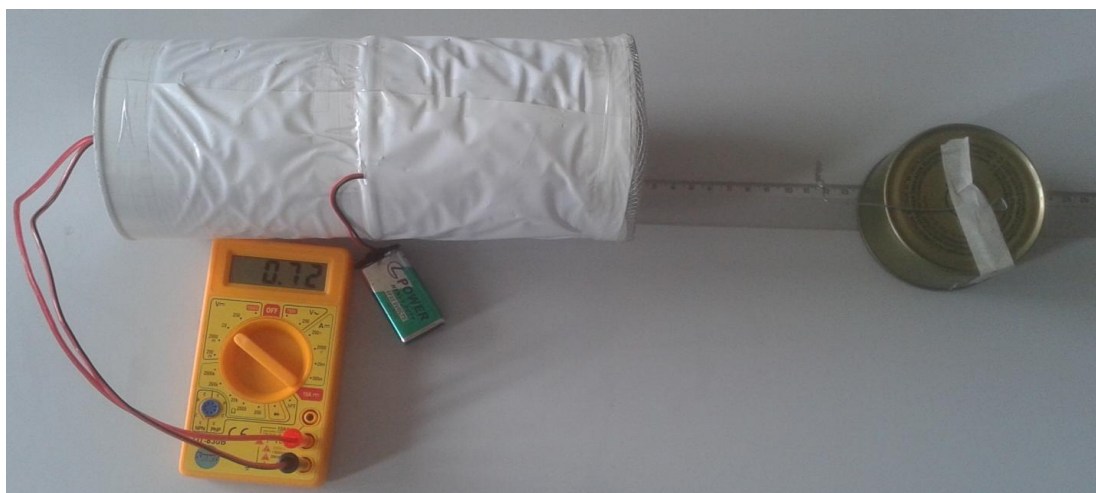
Figura 4 – Fonte de amerício colocada a 10cm da câmara de ionização
