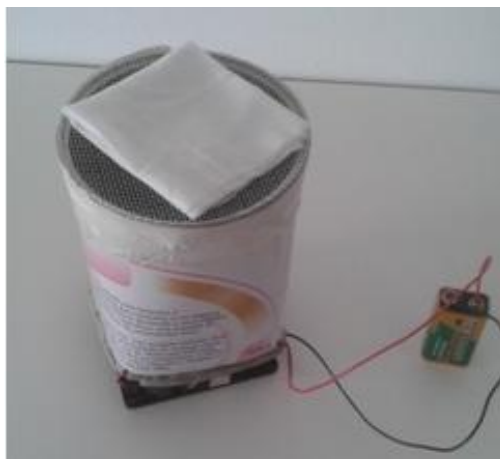
Figura 2 - Cooler adaptado com o filtro na janela de tela metálica.
