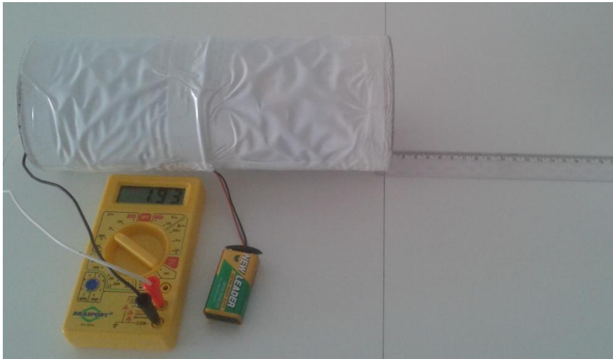
Figura 1 – Câmara de ionização ligada com a régua colocada paralela a ela.
