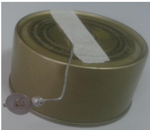
Figura 3 – Fonte de amerício presa a um suporte
