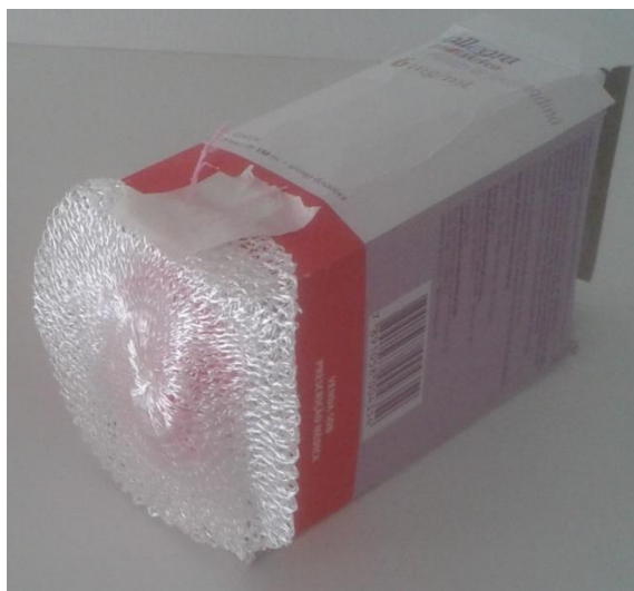
Figura 2 – Camisinha de lampião presa a um suporte.
