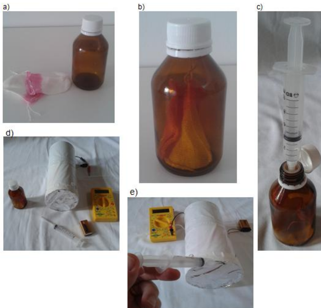
Figura 13 – a) Camisinha de lampião e vidro de remédio descartável. b) Camisinha de lampião dentro do vidro. c) Gás sendo retirado de dentro do vidro. d) Injetando gás dentro da câmara de ionização. e) Câmara de ionização com a janela coberta com papel alumínio e materiais utilizados na prática.
