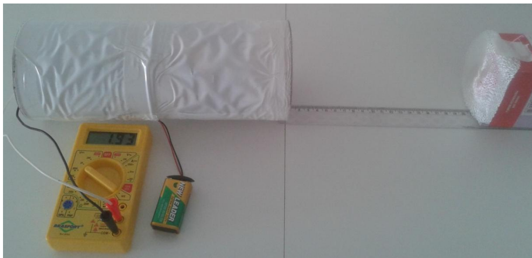
Figura 3 – Fonte colocada a distância de 20cm da câmara de ionização.
