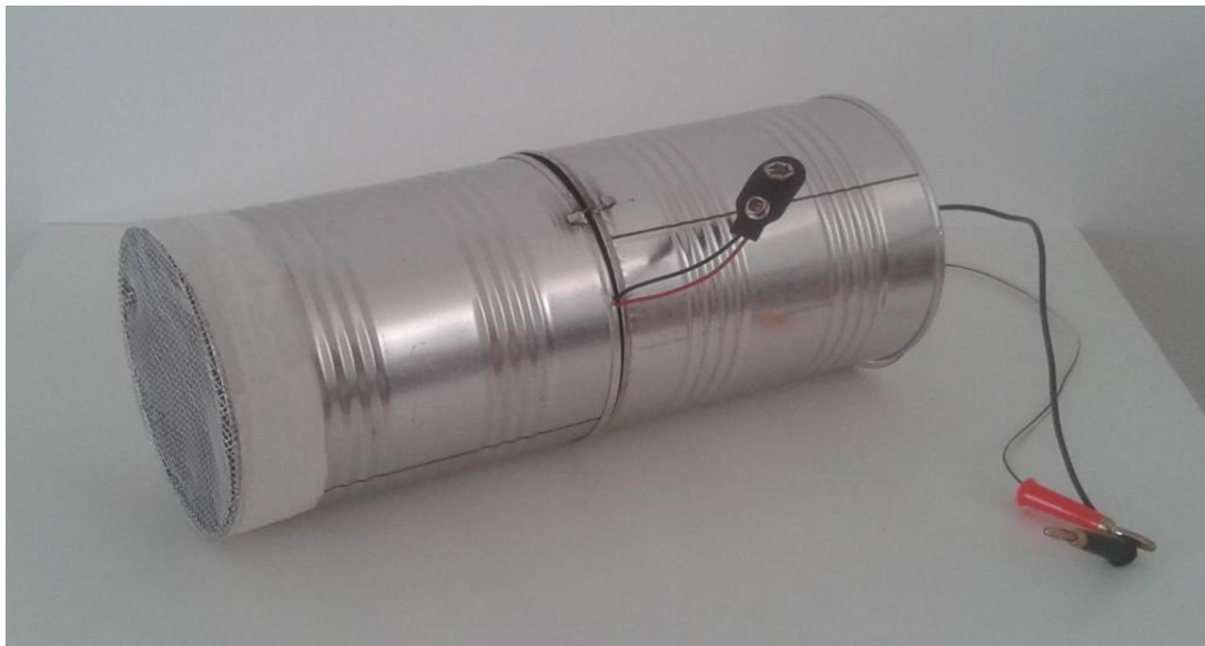
Figura 10 – Câmara pronta, com lata isolando o circuito amplificador.
