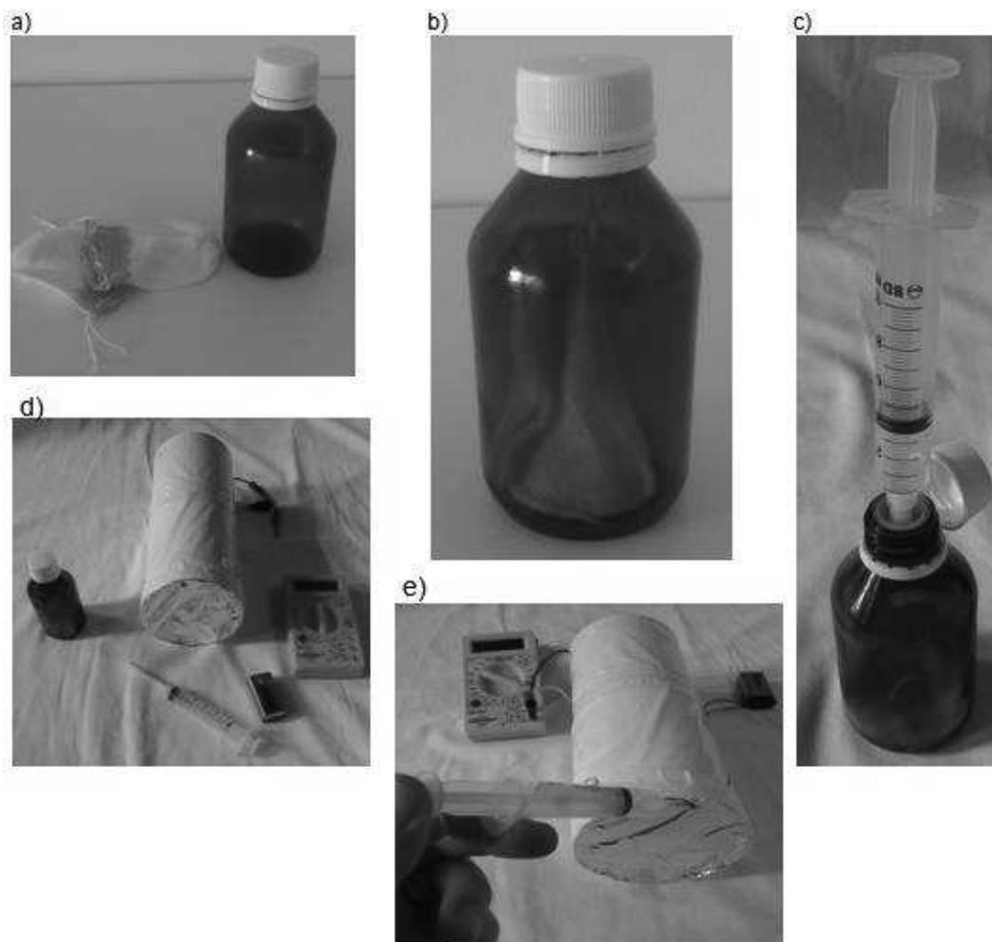
Figura 16 – a) Camisinha de lampião e vidro de remédio descartável. b) Camisinha de lampião dentro do vidro. c) Gás sendo retirado de dentro do vidro. d) Injetando gás dentro da câmara de ionização. e) Câmara de ionização com a janela coberta com papel alumínio e materiais utilizados na prática.
