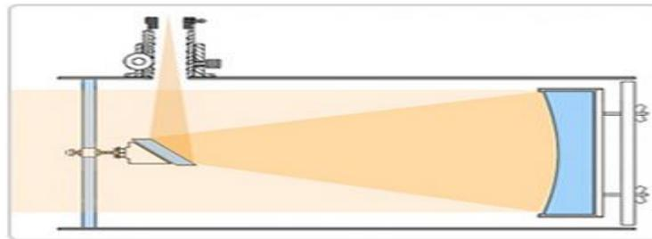
Figura 38: telescópio catadióptico do tipo Schmidt Newtoniano. Fonte: Santiago Filho, 2015.
