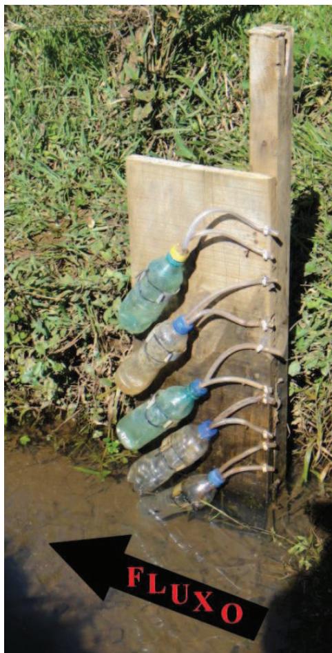
Figura 15: Amostrador de Nível Ascendente (ANA) construído e instalado no canal que se procedeu o monitoramento.
