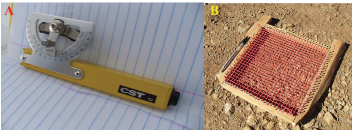
Figura 13: A: Clinômetro de mão/visual usado para mensurar a inclinação das estradas. B: Quadro de estimativa para mensurar a porcentagem de terra, seixo e vegetação que compõem o leito das estradas.
