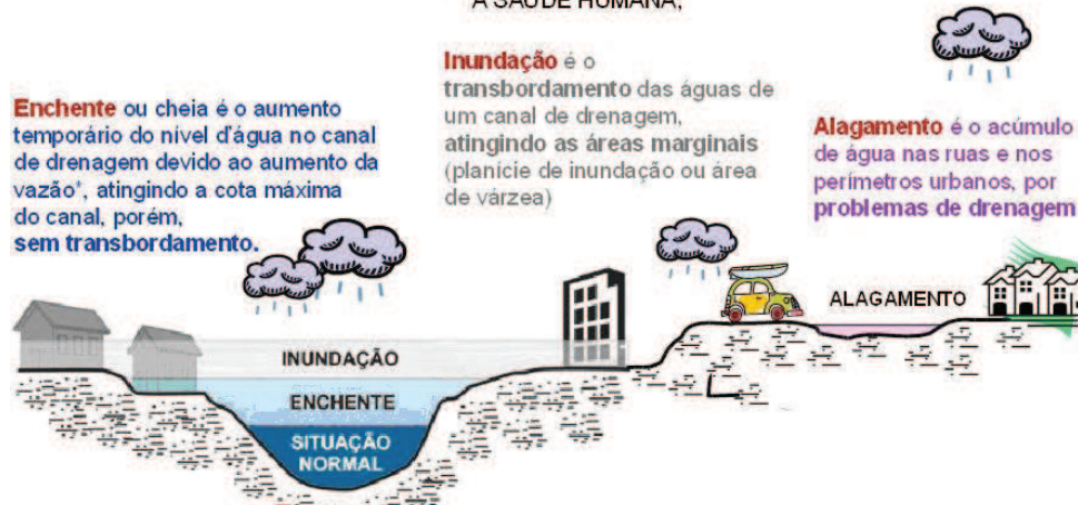
Figura 2.5 – Enchente, inundação e alagamento. Fonte: Defesa Civil de São Bernardo do Campo 17 .
