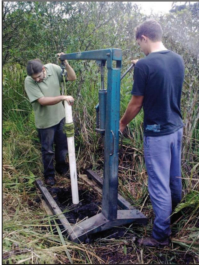
Figura 13: Extração de testemunho da Turfa Guará.
