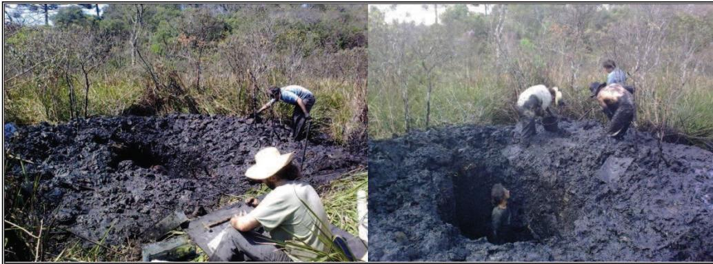
Figura 14: Vista da abertura da trincheira para extração de amostra indeformada.
