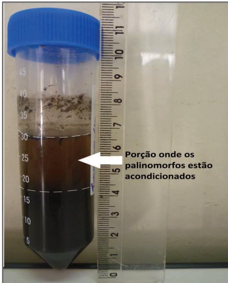
Figura 16: Resultado da separação palinomórfica, por meio de densidade.
