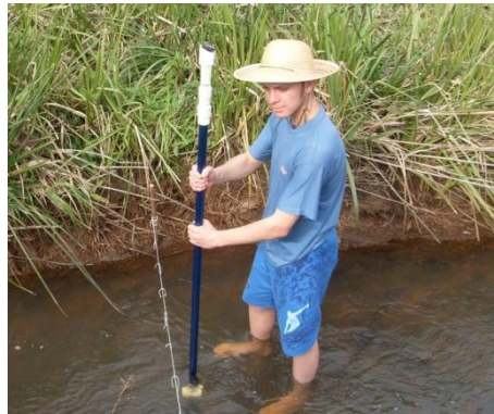
Figura 4.08 – Medição de Vazão no Arroio Monjolo Foto do autor (setembro de 2010)
