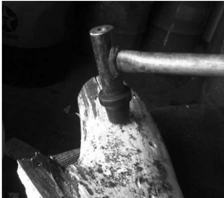
Figura 4: Martelo de aplicação utilizado para abertura de orifício para inoculação do nematóide no torete de 1 m de comprimento selecionado para a avaliação.
