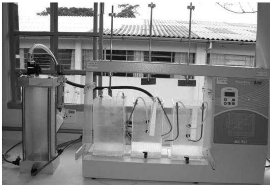
**Figura 14.** Equipamento flotateste utilizado nos ensaios.
