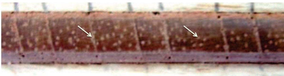
Figura 12. Anéis de crescimento de Cedrela fissilis , limitados por uma faixa de parênquima marginal apontado pela seta da esquerda, e o lenho inicial, indicado pela seta da direita.
