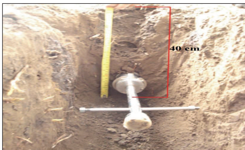
Figura 13. Vista frontal da trincheira com 40 cm de profundidade e trado com anel de Kopecky. Fonte: a autora.
