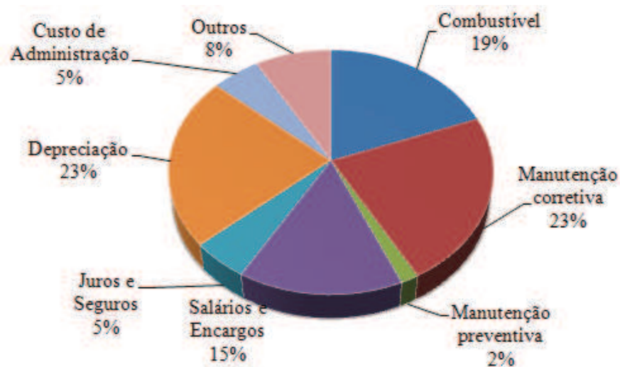
Figura 41. Distribuição percentual dos componentes do custo operacional do Processador Florestal harvester no sistema de colheita de árvores inteiras.
