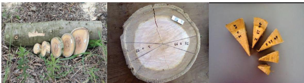
**Figura 7.** Etapas de coleta e preparo dos discos de 5 cm de *E. benthamii*, para a realização de ensaios de densidade básica e estabilidade dimensional. Foto: O autor (2013).
