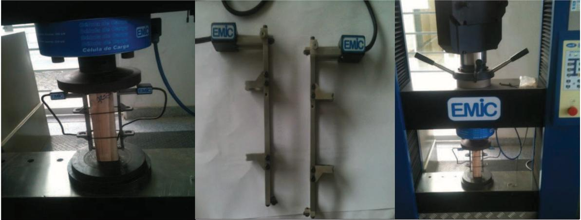
**Figura 10.** Representação do ensaio de compressão paralela às fibras, indicando o uso de extensômetro na mensuração do deslocamento das fibras.
