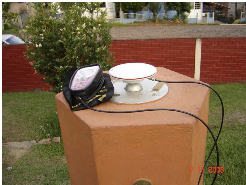
Figura 07 – Receptor GPS posicionado sobre Marco Geodésico integrante do SGB (Estação Homologada SAT 96014 / Irati, Rede Geodésica de Alta Precisão do Paraná)
