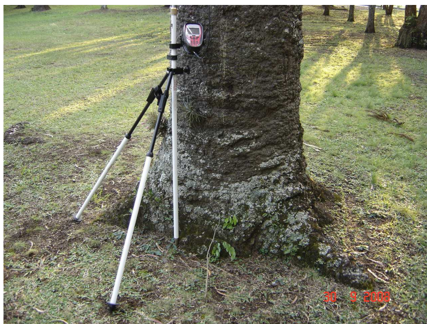
Figura 13 – Receptor DGPS fixado utilizando bipé
