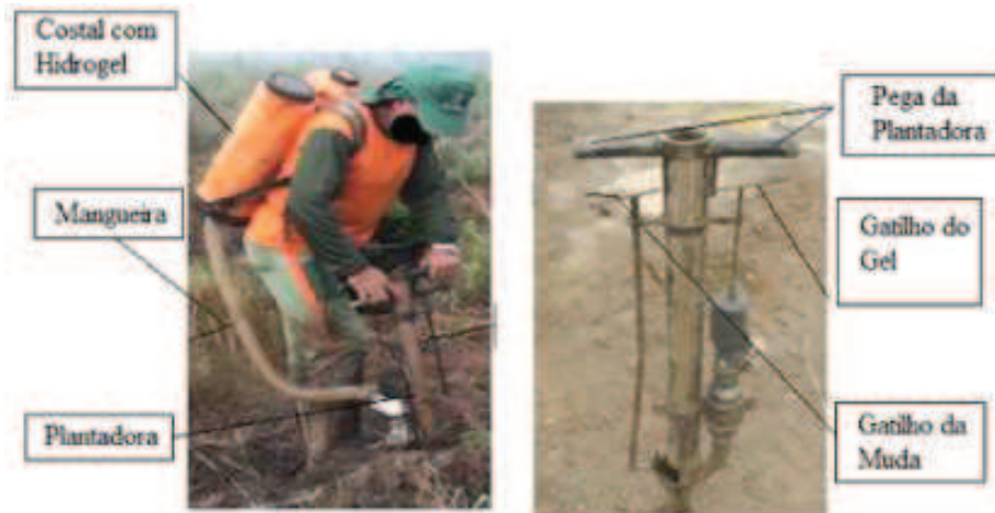
Figura 2 Plantio manual, em detalhe a plantadora avaliada na pesquisa.
