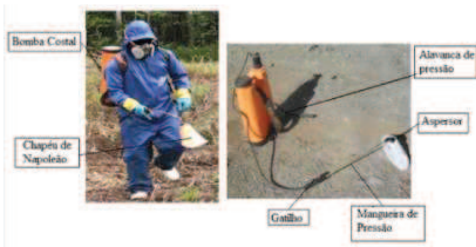
Figura 5 Aplicação manual de herbicida, em detalhe bomba costal.
