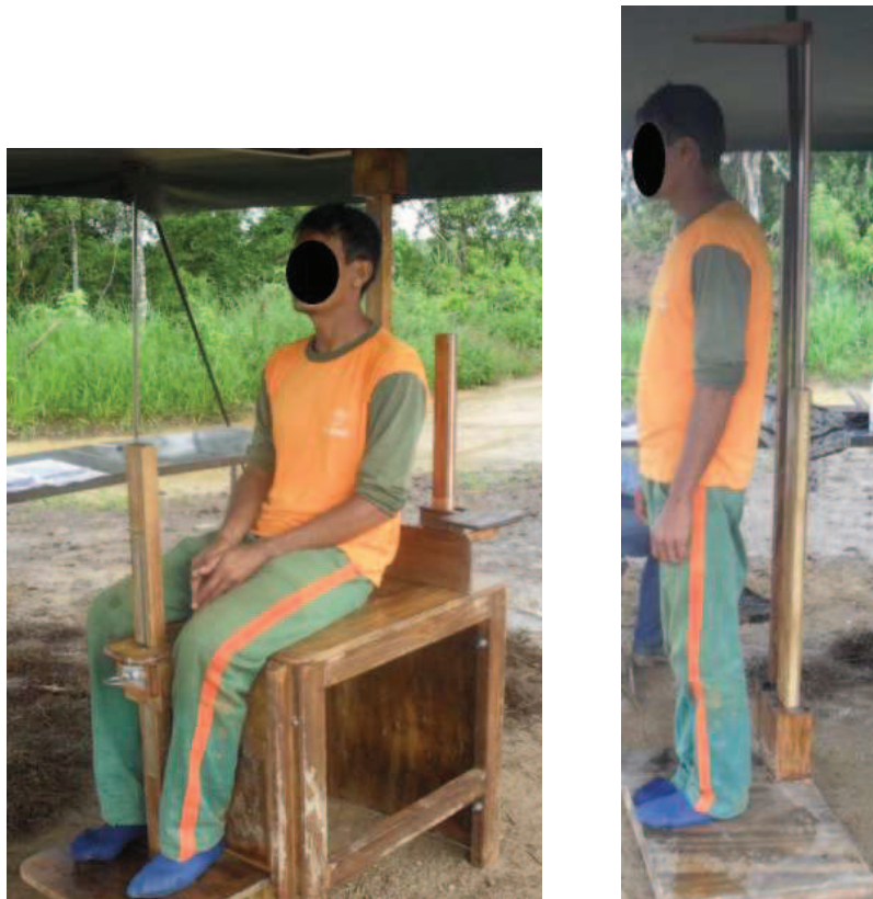
Figura 6 Cadeira e régua antropométrica utilizada no estudo. Fonte: Adaptado de Couto (1995)
