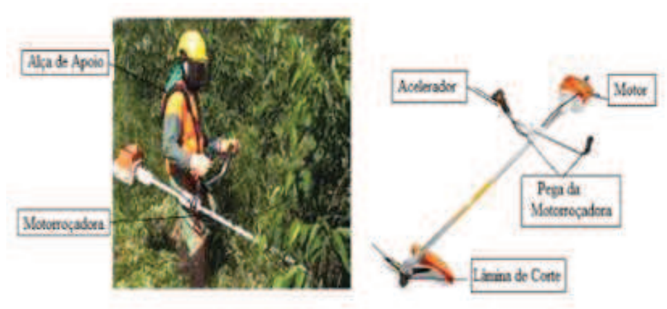
Figura 4 Roçada semimecanizada, detalhe da motorroçadora avaliada na pesquisa.
