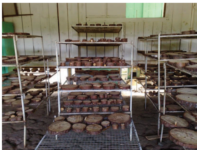
Figura 4: Fatias dispostas nas bandejas metálicas secando à sombra
