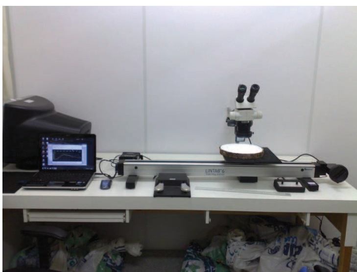
Figura 6: Equipamento LINTAB 6.0 em utilização
