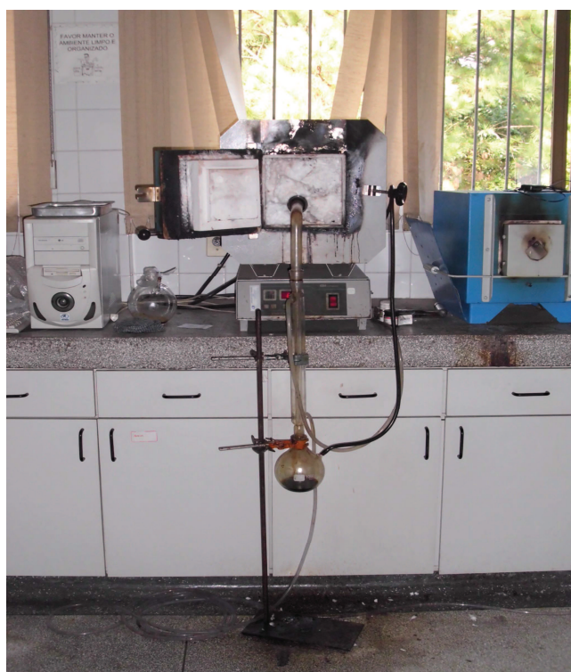
Figura 4.3 Forno mufla utilizado na carbonização das madeiras.
