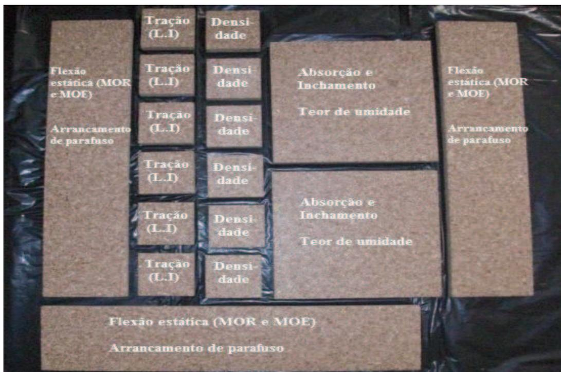
**Figura 6.** Esquema de corte dos corpos de prova.
