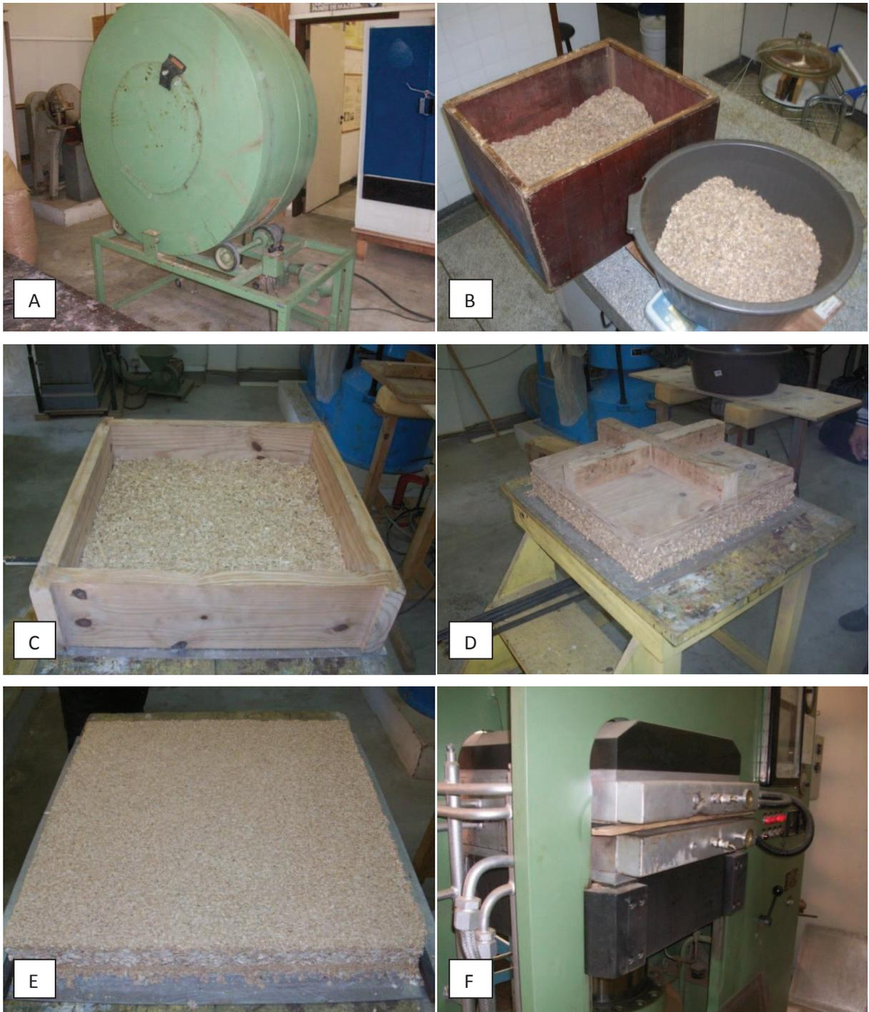
**Figura 5.** Confecção dos painéis. a) Encoladeira rotativa; b) Separação e pesagem de partículas; c) Formação do colchão; d) Colchão homogêneo; e) Colchão multicamada; f) Prensagem (consolidação do painel).
