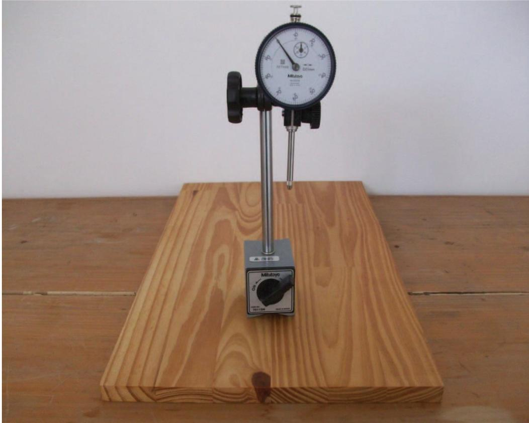
**Figura 8.** Instrumento de medição utilizado na determinação da espessura.
