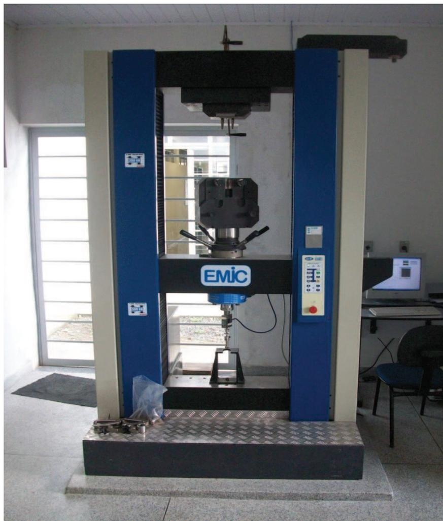
**Figura 7.** Máquina universal de ensaios mecânicos.
