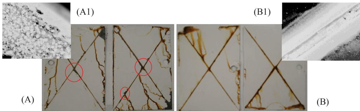
**Figura 64:** Fotografia do resultado da análise de salt spray, para amostra de aço carbono 1008. Em (A) tratado com nanocerâmica comercial e, (B) tratado com o sistema SAM 1 + Zr +Ti, pintados com tinta eletrostática pó poliéster branca após o ensaio. Os aumentos (A1 e B1) de 5x foram nas regiões do corte da amostra.
