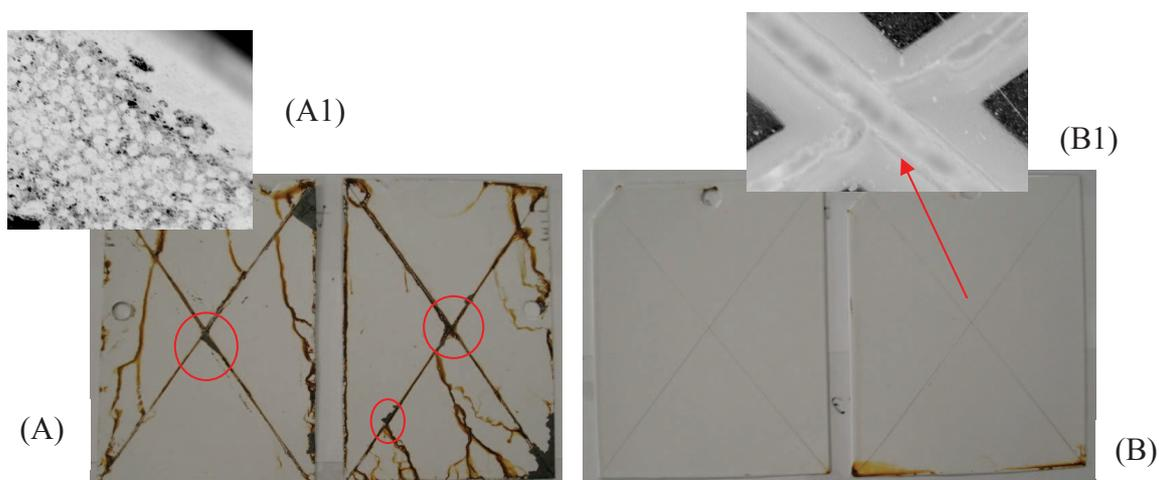
**Figura 54:** Fotografia do resultado da análise de salt spray, para amostra de aço carbono 1008. Em (A) tratado com nanocerâmica comercial e, (B) tratado com o sistema SAM2 + Zr, pintados com tinta eletrostática pó poliéster branca após o ensaio. Os aumentos (A1 e B1) de 5x foram nas regiões do corte da amostra.
