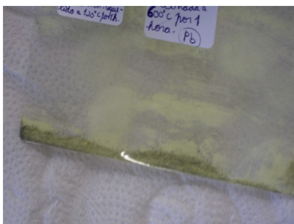
Figura 24 - Óxido resultante do processo de calcinação da resina 2 a 600°C, após ser retirado do cadinho onde foi sinterizado.
