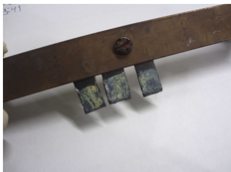
Figura 13 - Eletrodos de grafite presos no suporte de aço inoxidável.
