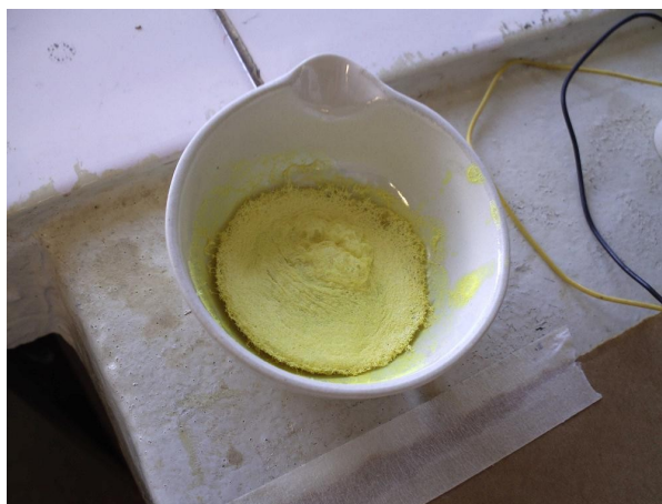
Figura 23 – Óxido expandido obtido pela calcinação da resina 2 de chumbo a 500°C.
