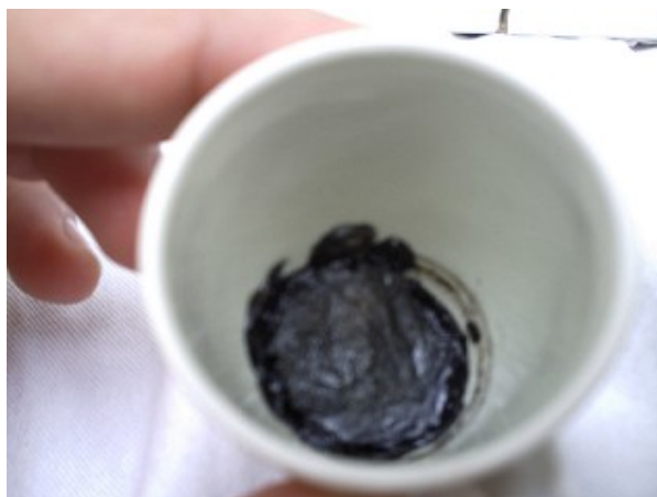
Figura 28 - Aspecto do material semicarbonizado obtido da calcinação da resina contendo persulfato de amônio.
