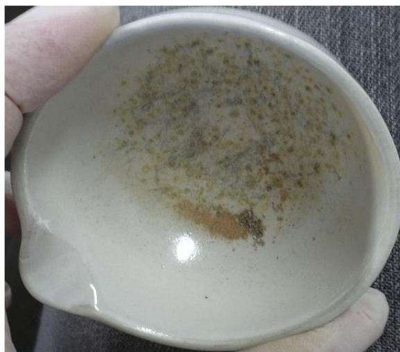
Figura 25 b) - Aparência dos óxidos resultantes da calcinação da resina 2 a 700°C após raspados do cadinho.
