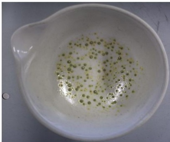
Figura 25 a) - Aparência dos óxidos resultantes da calcinação da resina 2 a 700°C.
