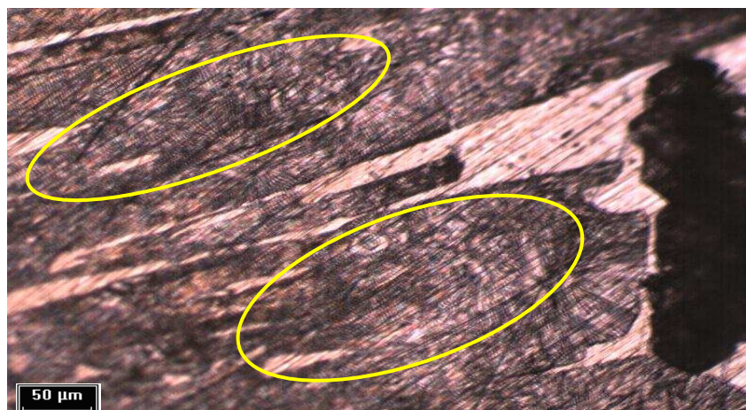
Figura 36d: Aço 316 após imersão em \text{Na}_2\text{SO}_4 0,5 \text{ mol L}^{-1} com 10% de E. coli .
