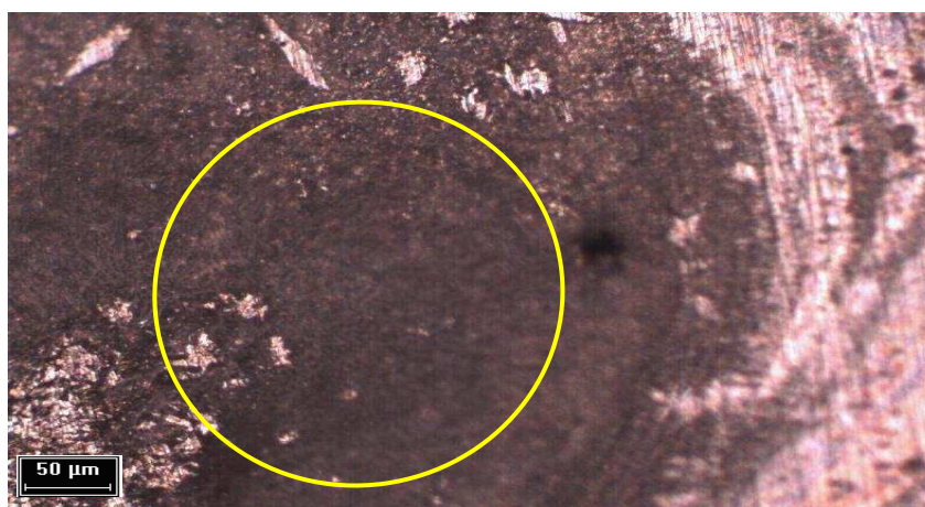
Figura 37d: Aço 316 após imersão em \text{Na}_2\text{SO}_4 0,5 \text{ mol L}^{-1} com 10% de E. coli .
