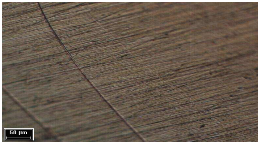
Figura 35a: Aço 316 após imersão em \text{Na}_2\text{SO}_4 0,5 \text{ mol L}^{-1} sem E. coli .
