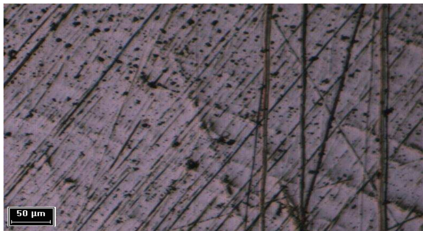
Figura 36a: Aço 316 após imersão em \text{Na}_2\text{SO}_4 0,5 \text{ mol L}^{-1} sem E. coli .
