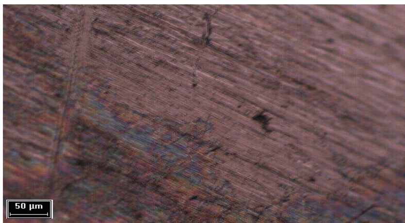
Figura 37a: Aço 316 após imersão em \text{Na}_2\text{SO}_4 0,5 \text{ mol L}^{-1} sem E. coli .
