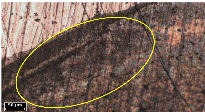
Figura 35d: Aço 316 após imersão em \text{Na}_2\text{SO}_4 0,5 \text{ mol L}^{-1} com 10% de E. coli .
