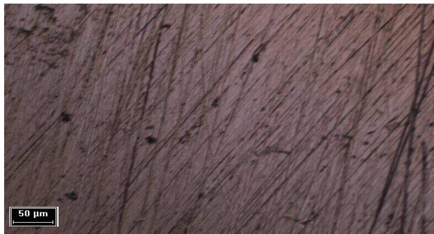
Figura 37b: Aço 316 após imersão em \text{Na}_2\text{SO}_4 0,5 \text{ mol L}^{-1} com 0,1% de E. coli .
