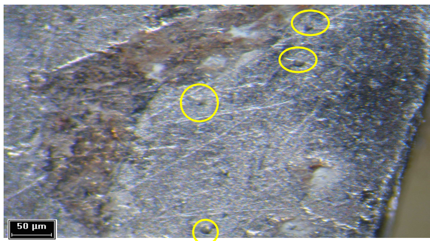
Figura 37e: Aço 316 que teve o biofilme removido por polarização anódica após 48 horas de imersão em \text{Na}_2\text{SO}_4 0,5 \text{ mol L}^{-1} com 10% de E. coli .
