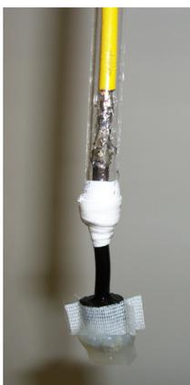
**Figura 10.** Eletrodo tubular constituído por pasta de sulfato tribásico de chumbo após a formação em solução de  $H_2SO_4$ .
