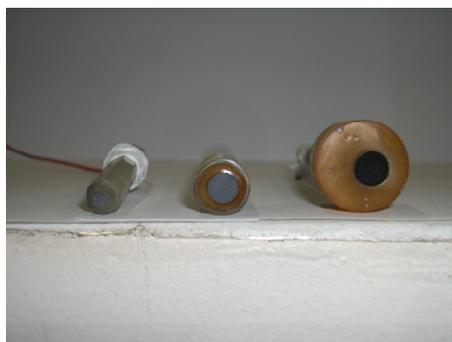
**Figura 12.** Eletrodos planos (Planté) produzidos em laboratório com diferentes áreas geométricas.
