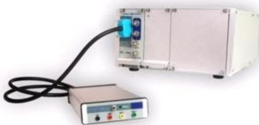
**Figura 17.** Potenciostato modelo PG39 A, da Omnimetra, utilizado para o desenvolvimento dos ciclos galvanostáticos [34].
