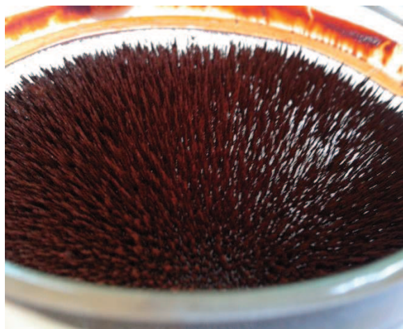
FIGURA 17. AMOSTRA DE MAGNETITA SINTETIZADA SOBRE O IMÃ.
