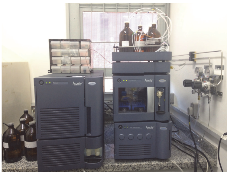
Figura 9 - Cromatógrafo líquido de ultra eficiência empregado nas análises de identificação dos componentes polares no extrato metanólico de A. brasiliensis .
