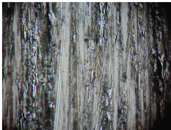
Figura 10. Micrografia da lamina de vidro com ampliação de 100 vezes após o lixamento.
