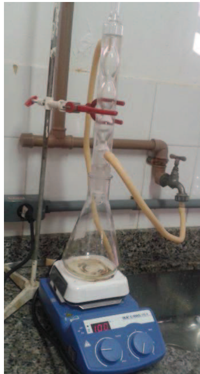
Figura 14. Aparato para a determinação do índice de saponificação.
