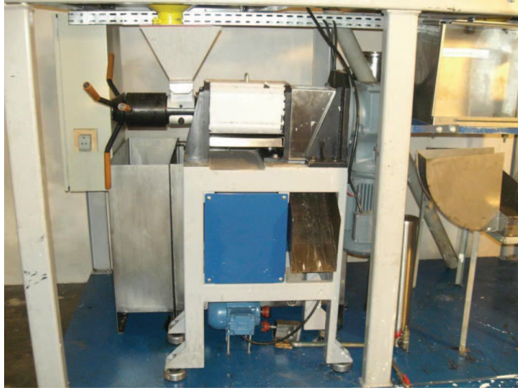
Figura 12. Prensa Scott Tech instalada na Mini-Usina (Pitanga – PR) para extração do óleo vegetal
