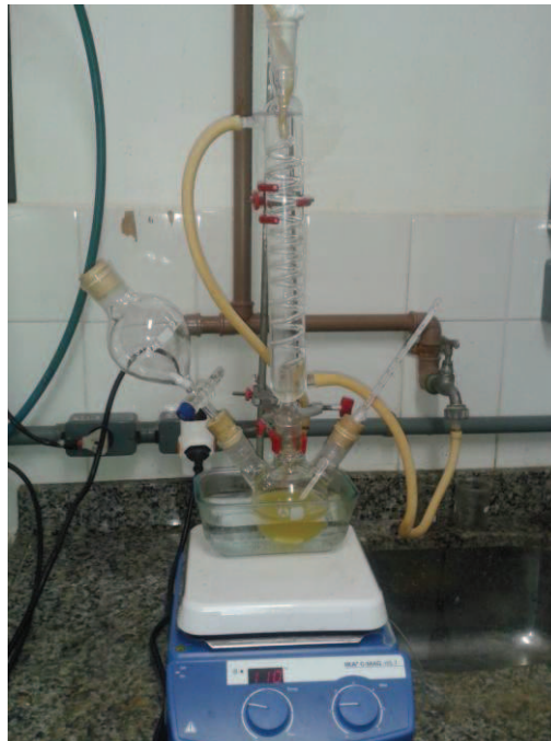
Figura 16. Aparato para a reação de transesterificação do biodiesel.
