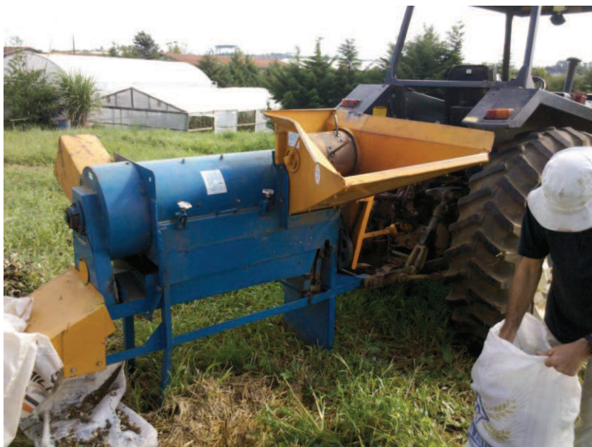
Figura 10. Máquina trilhadeira utilizada para debulhar os capítulos de girassol.
