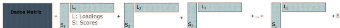
Figura 9. A matriz \mathbf{X} ao sofrer a transformada se decompõe em matrizes menores e uma matriz de resíduo.
