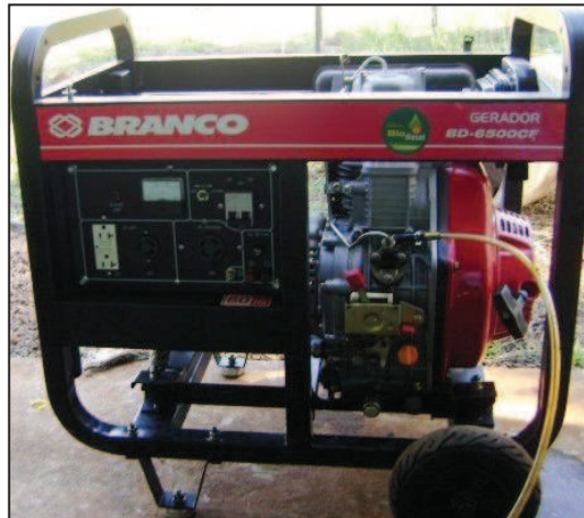
Figura 4 – Motor gerador utilizado nos ensaios
