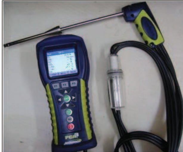
Figura 6 - Analisador automático Bacharach, modelo PCA3
