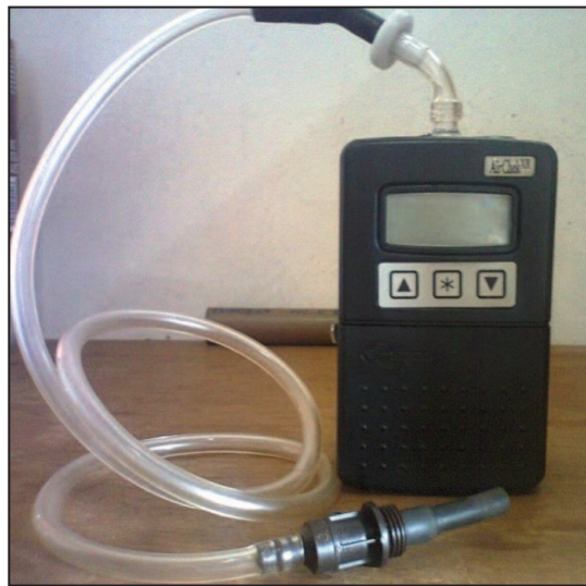
Figura 10 - Bomba portátil usada nas amostragens de material particulado e gases orgânicos Fonte: Acervo da autora (2011).
