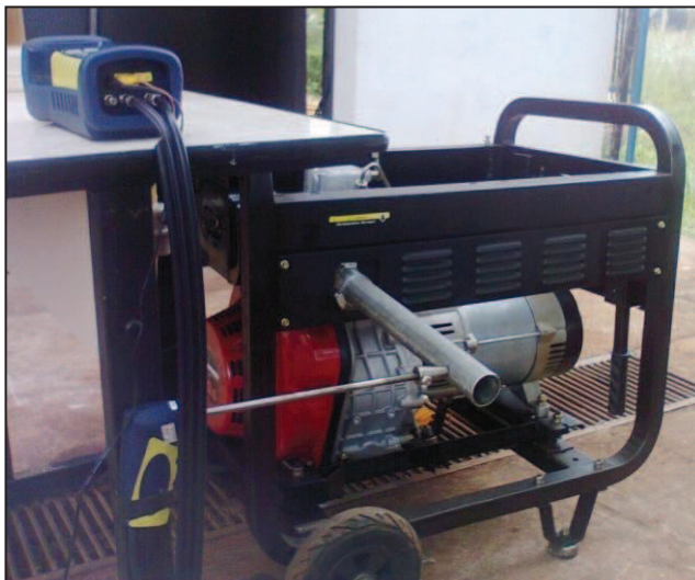
Figura 7 – Posicionamento da sonda do analisador no motor para avaliação de emissões de gases inorgânicos Fonte: Acervo da autora (2011).
