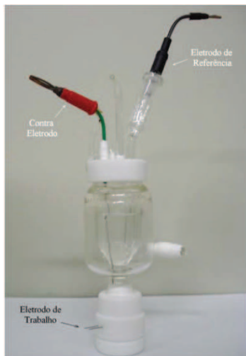
Figura 13: Fotografia da célula eletroquímica utilizadas nas medidas de MECQ [22] .
