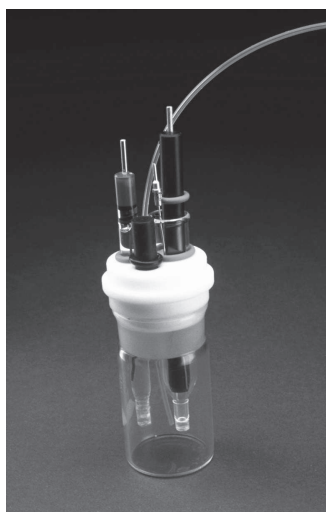
Figura 12: Fotografia da uma célula eletroquímica convencional com 3 eletrodos: trabalho, referência e contra eletrodo [7] .
