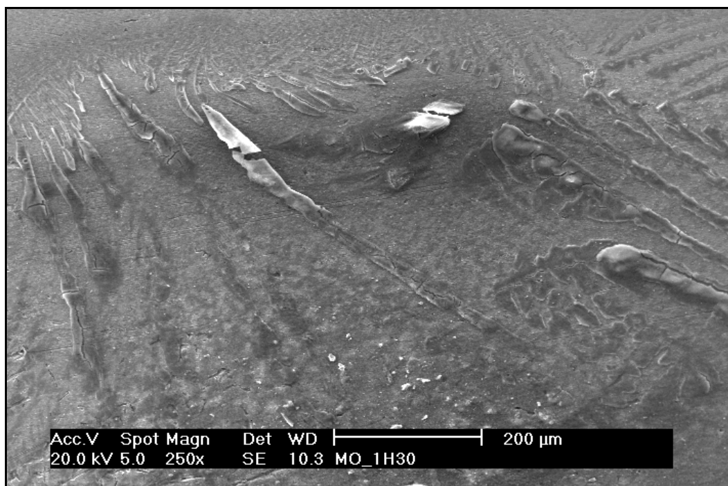
Figura 5.19 – Imagem gerada por microscópio eletrônico de varredura para o aço inoxidável 430 após imersão por 1 hora em H 2 SO 4 1 mol L -1 com microorganismos.
