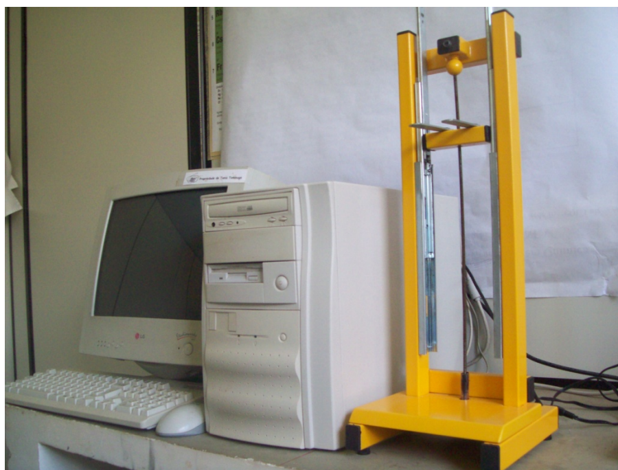
Figura 14. Equipamento utilizado no processo Dip Coating .
