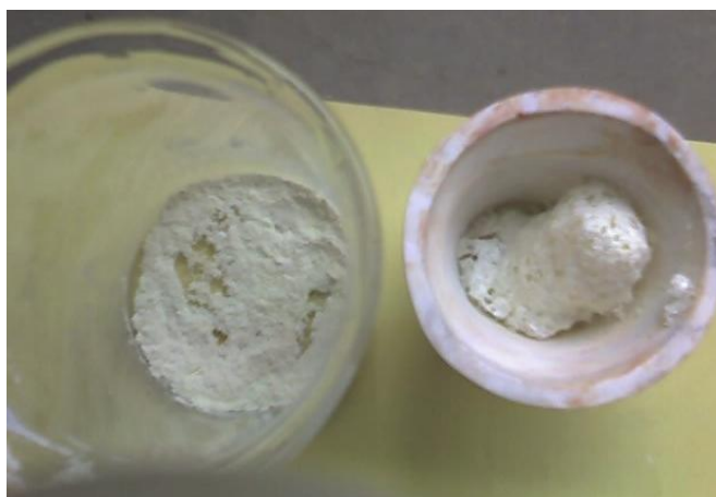
Figura 5.1. Fotografia dos pós cerâmicos após tratamento térmico final, a direita o “ puff ” e a esquerda o pó proveniente da maceração do “ puff ”.
