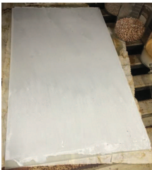
FIGURA 155: TiO 2 IMOBILIZADO NA SUPERFÍCIE
