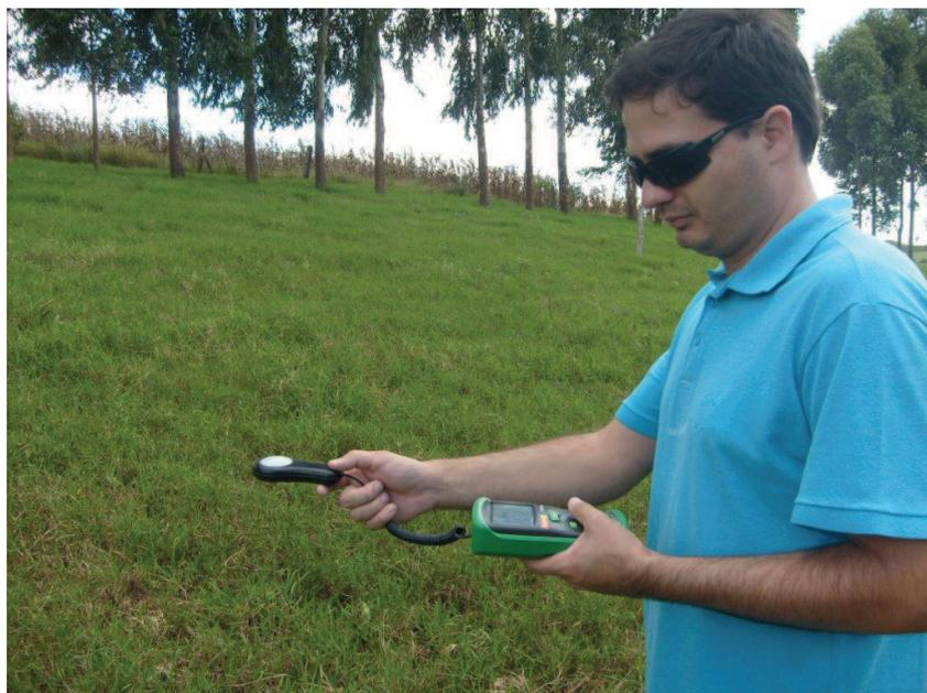
Figura 16. Amostragem da luminosidade: uso do luxímetro digital
