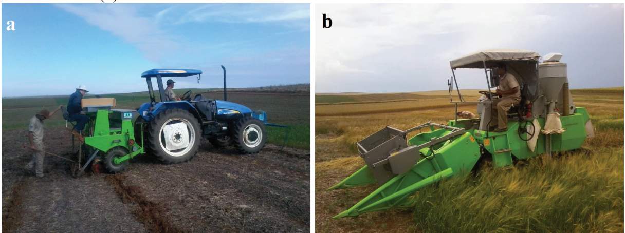
Apêndice V. Processo de semeadura das parcelas com semeadora de parcelas Semina (a); colheita de parcelas do experimento com colhedora de parcelas Wintersteiger (b).
