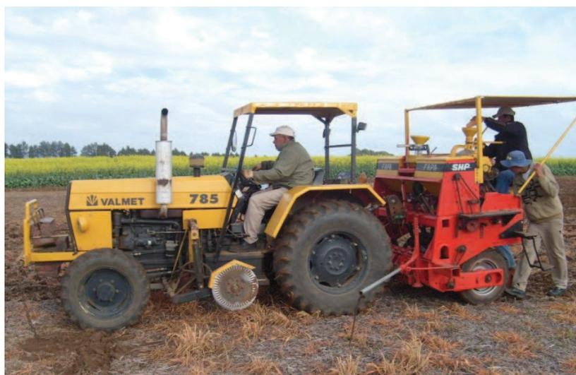
**Figura 4.** Trator adaptado para práticas experimentais, acoplado a semeadora de parcelas SHP com dosador de sementes e adubo.
