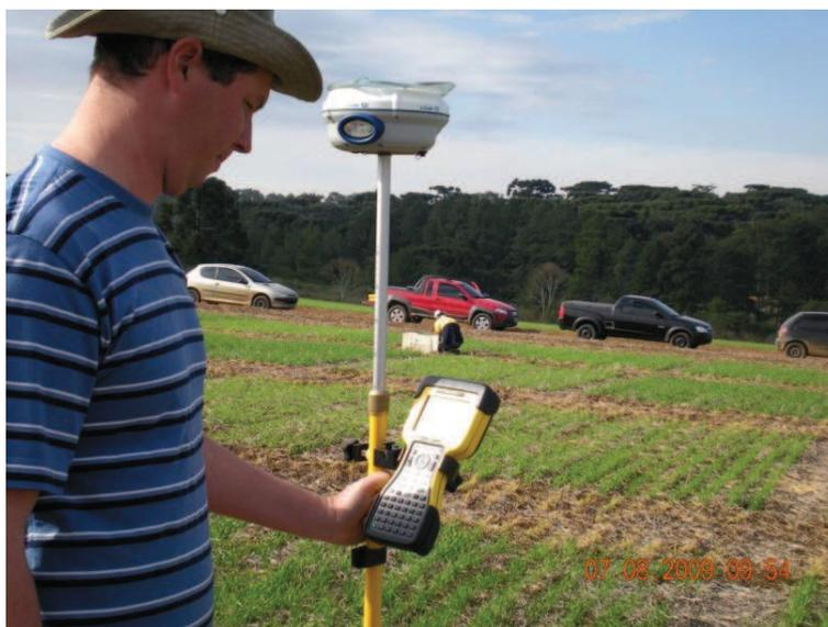
**Figura 8.** Levantamento de coordenadas dos vértices das parcelas com GPS Trimble R6 e sua coletora de dados.
