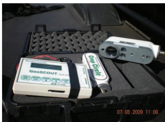
**Figura 7.** Sensor ativo Crop Circle®, destacando-se o *data logger* a esquerda e os dois sensores ópticos ativo, a direita da imagem.
