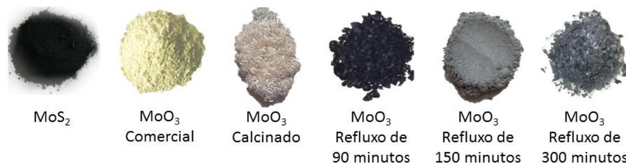
**Figura 15.** Fotografia do precursor  $\text{MoS}_2$ , do  $\text{MoO}_3$  comercial e dos óxidos obtidos pela calcinação e por refluxo nos seus respectivos tempos de síntese.
