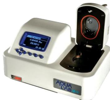
**Figura 2.9.** Modelo de medidor de atividade de água (Disponível em: <http://aqualab.decagon.com.br/> Acesso em 27/01/2015).
