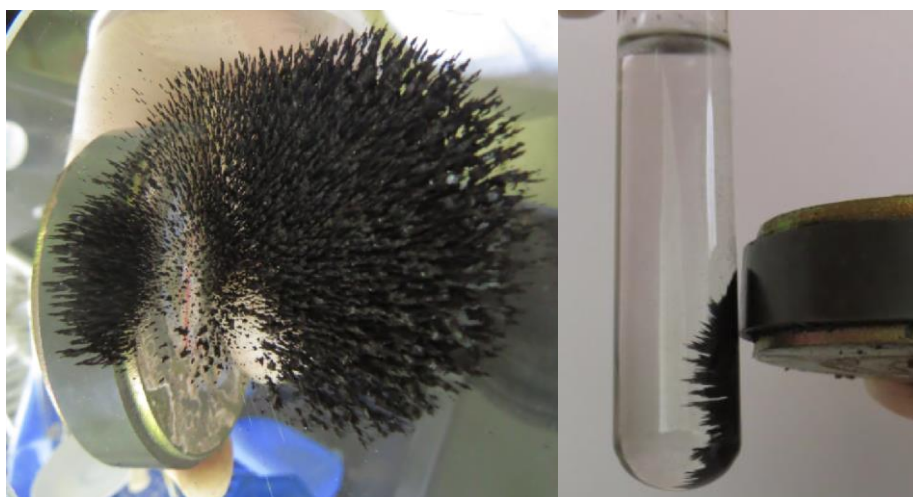
Figura 20: NPsM de \text{CoFe}_2\text{O}_4 obtida pelo método de coprecipitação, em pó e em meio dispersante.
