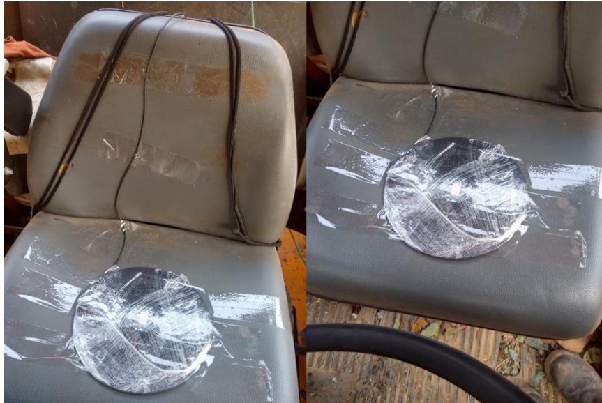
Figura 8. Medidor de vibração de corpo inteiro com acelerômetro instalado no assento da máquina.
