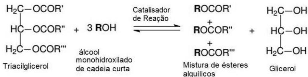
Esta reação se baseia na mistura do óleo (triglicerídeo - TAG) com um álcool de cadeia curta (metanol, etanol) na presença de um catalisador o qual pode apresentar caráter ácido, básico ou enzimático. Isso resulta na substituição do grupo éster do glicerol pelo grupo álcool, como subproduto desta reação será formada a glicerina. (SILVA; FREITAS, 2008)
