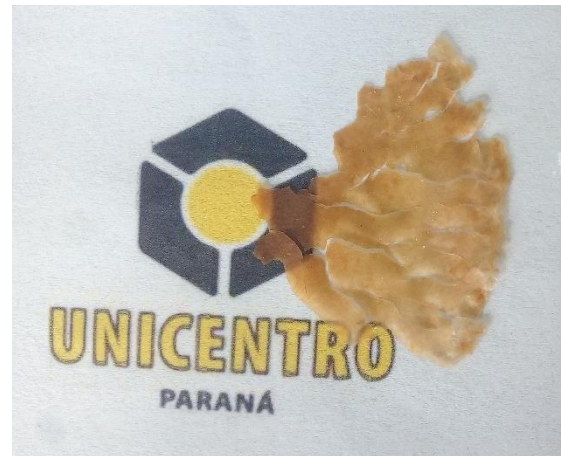
Figura 44: Membrana quitosana/alginateo contendo Ibuprofeno solubilizado em etanol (50 %v/v).
