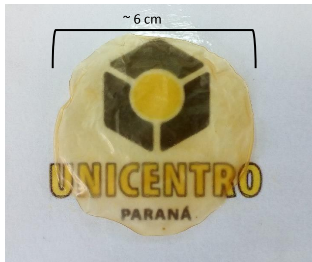
Figura 42: Membrana quitosana/alginato obtida após os processos de imersões.
