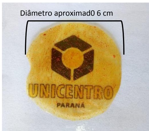
Figura 39: Membrana de quitosana/alginato solubilizada em ácido acético/acetona.
