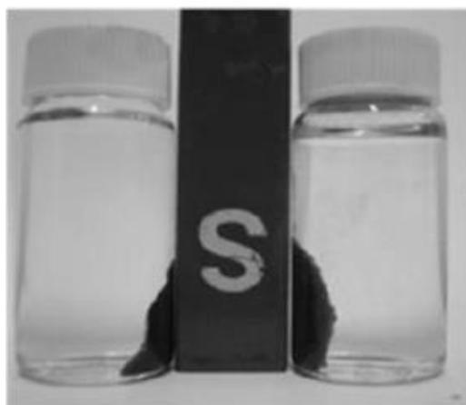
**Figura 15.** Processo de separação de microesferas magnéticas de quitosana/poli(ácido acrílico) a partir de uma suspensão aquosa.<sup>41</sup>
