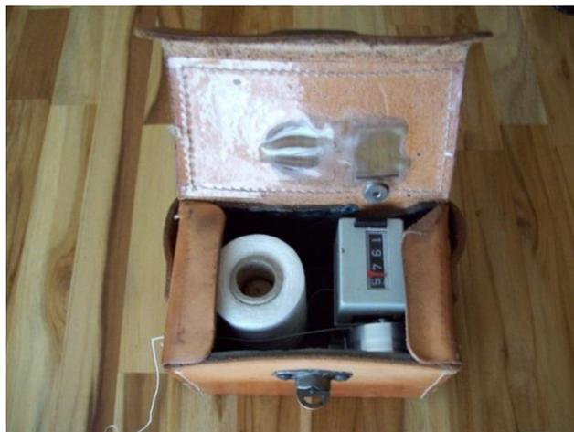
**Figura 7.** Medidor de distância utilizado para mensurar distâncias ao longo das faixas de extração.
