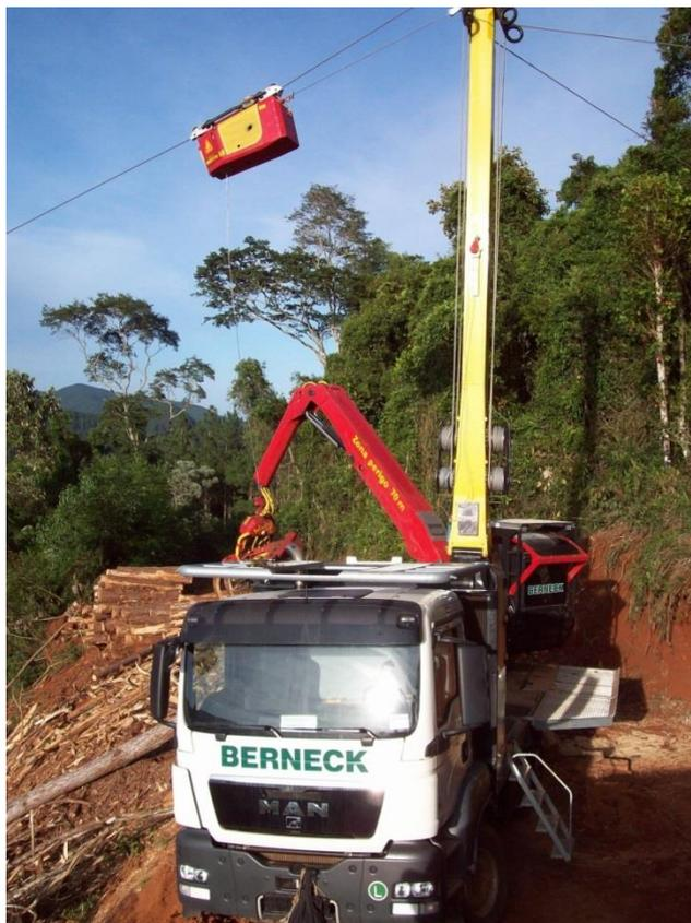
**Figura 6.** Veículo e torre principal do sistema de cabos aéreos montado na estrada florestal.
