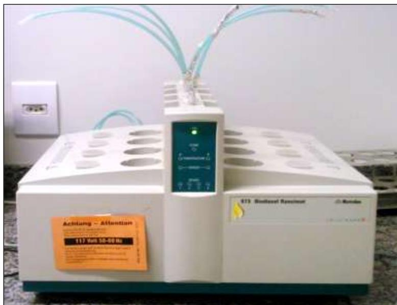
**Figura 4**– Equipamento 873 Biodiesel Rancimat - Metrohm®.
