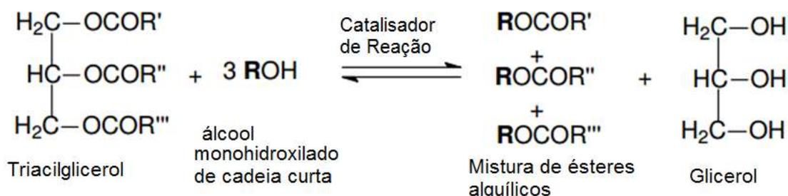
**Figura 1** – Reação de transesterificação do biodiesel.
