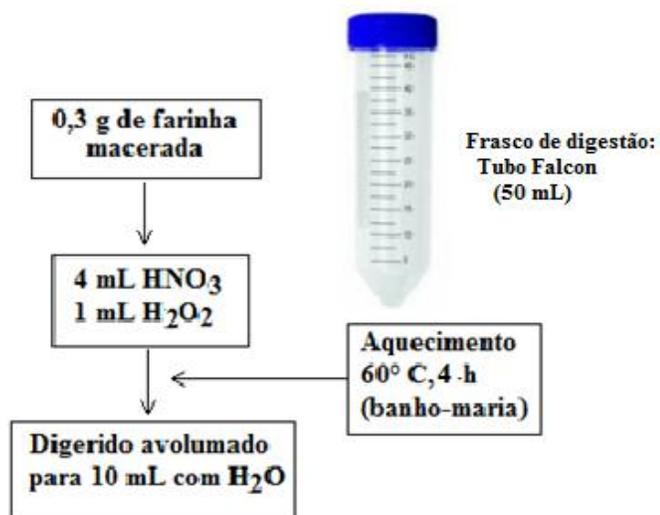
**Figura 10.** Procedimento 2: Digestão de farinha de milho (amostra A1) usando tubo Falcon de 50 mL e aquecimento em banho-maria.
