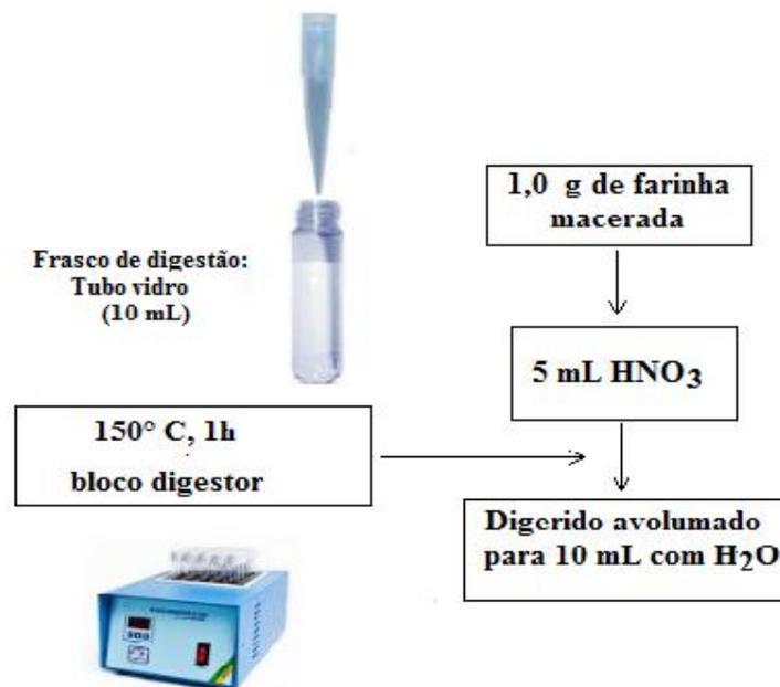
**Figura 14.** Procedimento 6: Digestão da farinha de milho (amostra A1) usando tubos de vidro de 10 mL e bloco digestor (150°C).
