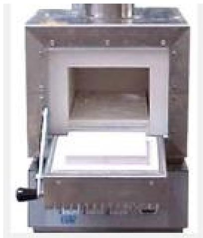
**Figura 2:** Fotografia de forno mufla para digestão por via seca (Fonte: Google Imagens)
