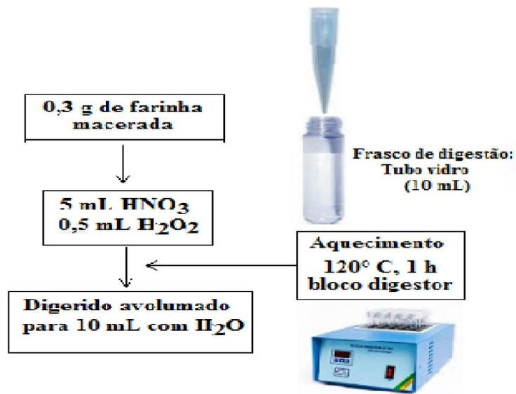
**Figura 12.** Procedimento 4: Digestão da farinha de milho (amostra A1) usando tubos de vidro de 10 mL e bloco digestor (120°C).
