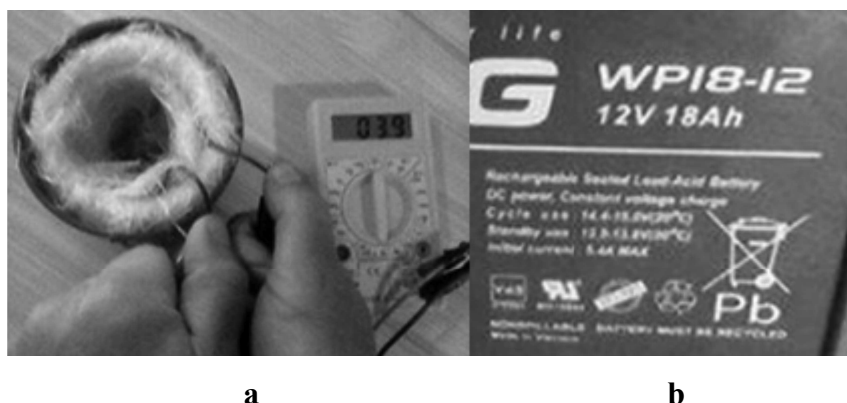
Figura 19 a. Medida da resistência medida na manta, b. Característica da bateria.
