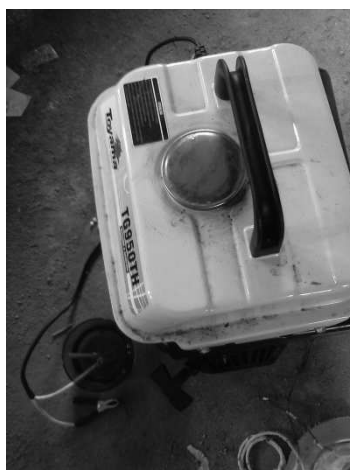
Figura 10. Gerador elétrico 110V e 12V tocado a gasolina.
