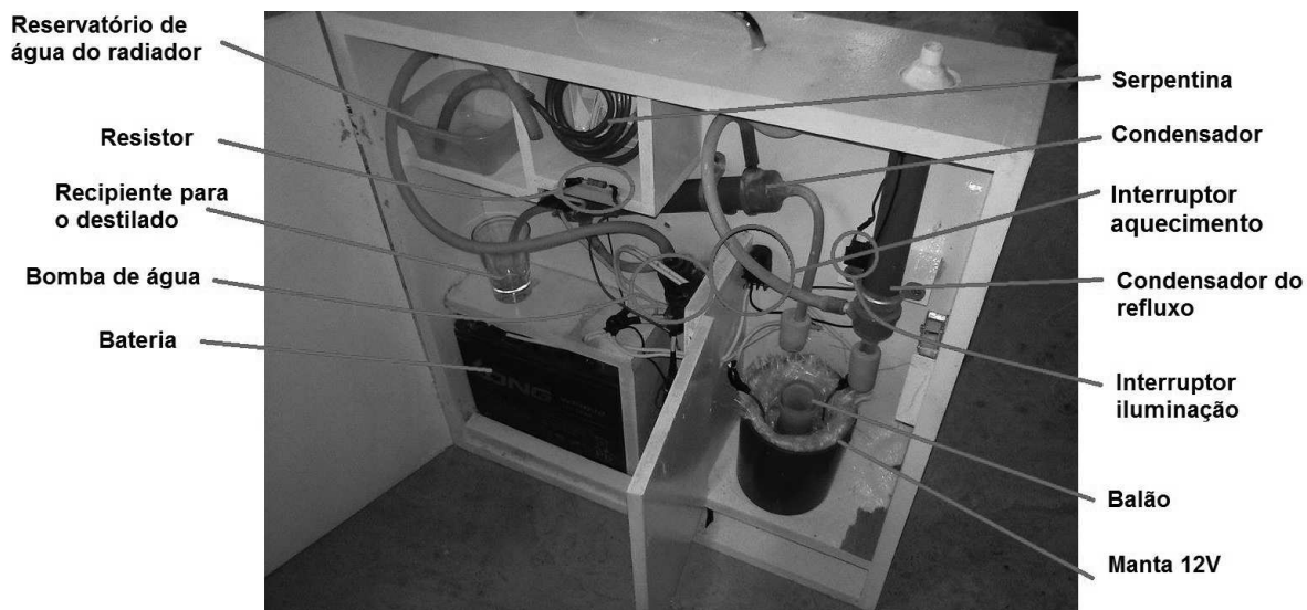
Figura 16. Vista frontal do sistema de refluxo e destilador.
