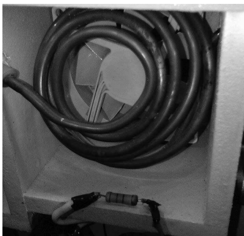
Figura 17. Sistema de serpentina para refrigeração.
