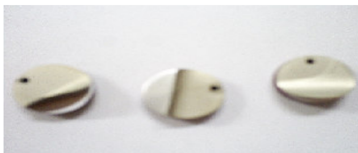
Figura10: Imagem das placas de alumínio contendo o filme de níquel deslocado antes da utilização de HF.
