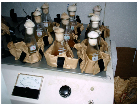
Figura 8: Amostras das triplicas dos meios nº 1, 2 e 3 respectivamente, em Shaker a 30 °C com agitação de 150 rpm.
